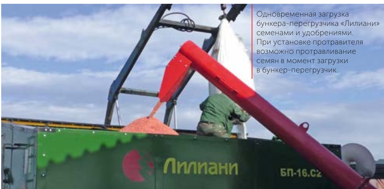
Для работы в рисовых чеках или на полях со слабым грунтом ваша компания может применять бункер-перегрузчик «Лиллиани» с 8-колесной подвеской. Благодаря системе двойного балансира и использованию широкопрофильных шин бункер-перегрузчик создает низкое давление на почву и позволяет полностью исключить необходимость выхода комбайнов за пределы поля для выгрузки.
