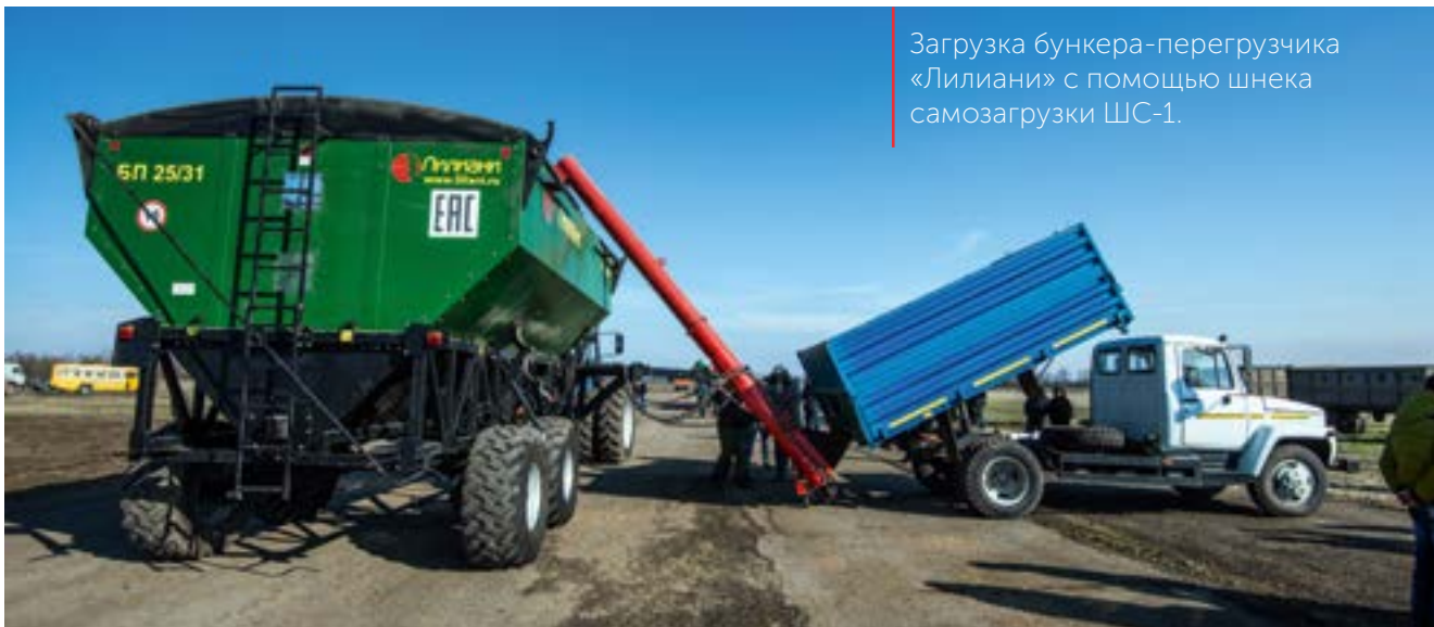
Одновременная загрузка бункера-перегрузчика «Лиллиани» семенами и удобрениями. При установке протравителя возможно протравливание семян в момент загрузки в бункер-перегрузчик.
