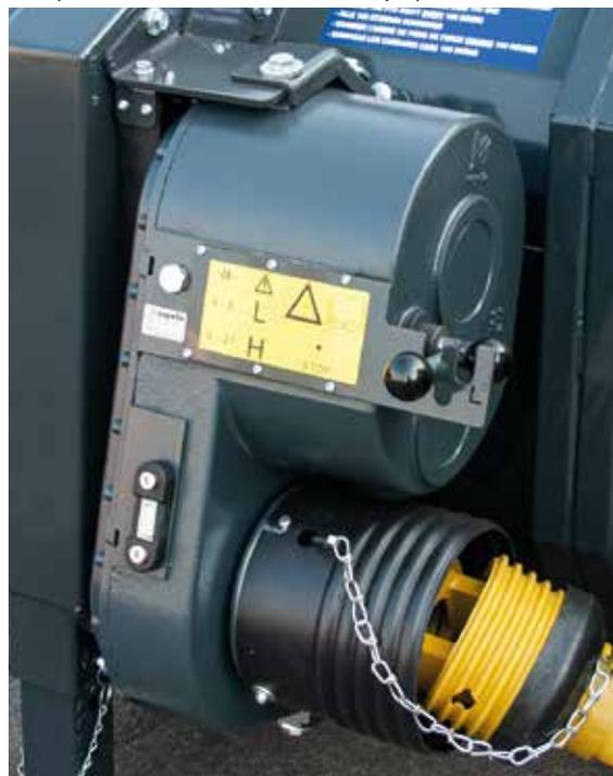
Идеальная проходимость: усиленная внешняя коробка передач имеет переключатель скоростей с тремя положениями, с помощью которого регулируется скорость вращения шнека и, соответственно, степень измельчения.
