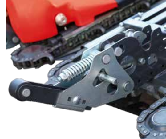
Система „анти шок“ – при контакте с землей делители автоматически откидываются вверх, оставаясь невредимыми.
